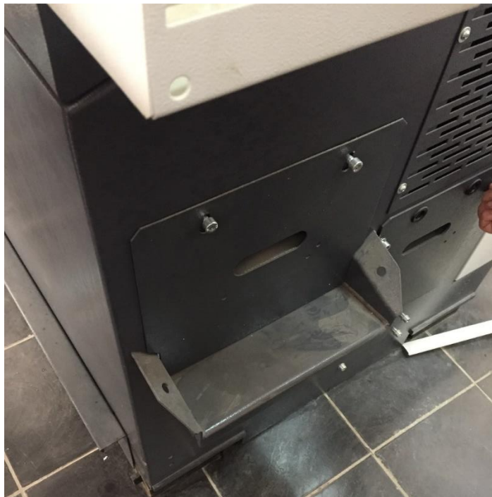
شكل رقم ٢٨: فك مسامير درج الرايش
