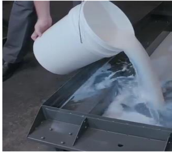
شكل رقم ١١: صب خليط زيت التبريد في درج الزيت
