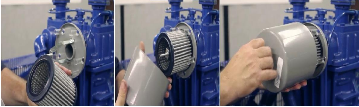
شكل رقم ٧٥: فحص فلتر الهواء
