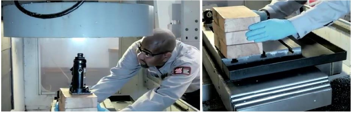
شكل رقم ٣٨: وضع كوريك وقطع خشبية اسفل برج العدة
