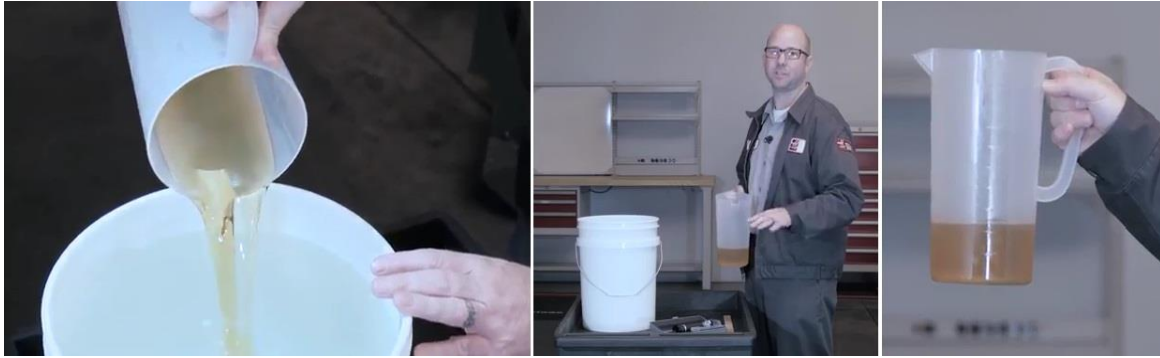
شكل رقم ٨: صب زيت التبريد المركز على الماء
