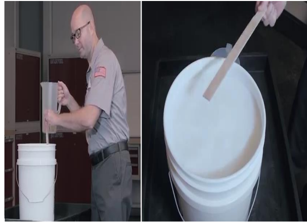
شكل رقم ٩: تقليب خليط زيت التبريد
