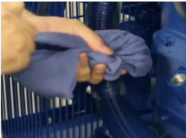
شكل رقم ٧٤: تنظيف عصا الزيت قبل ارجاعها
