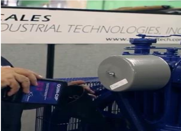
شكل رقم ٧٣: ملئ خزان الزيت
