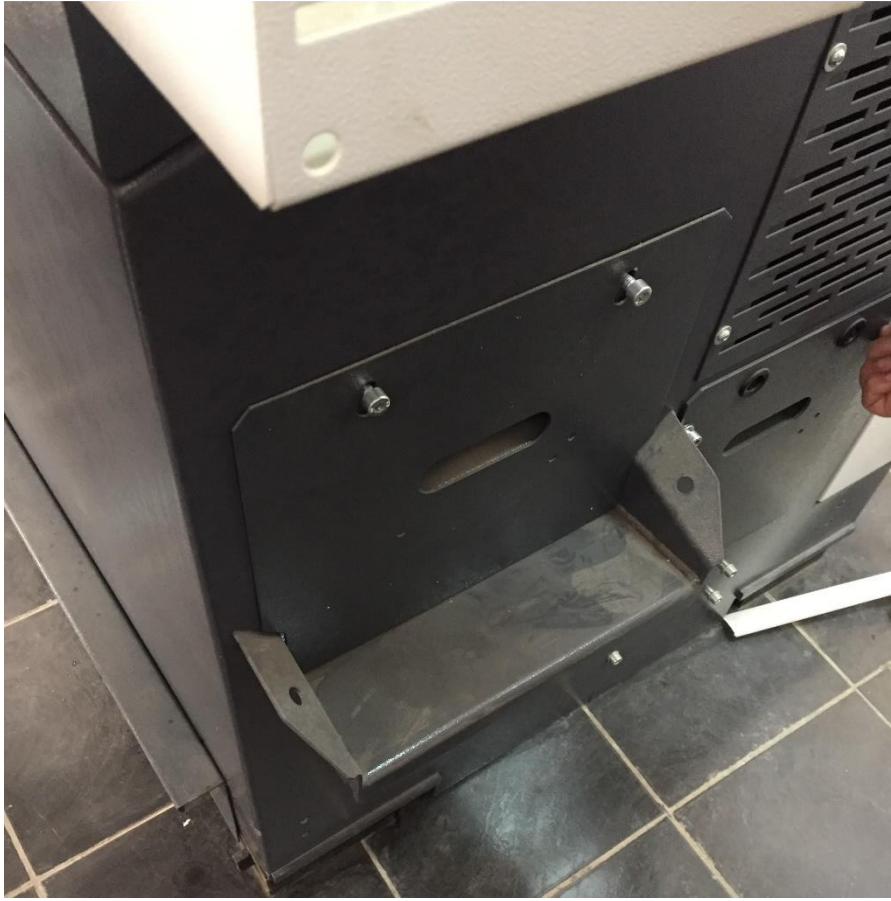
شكل رقم ٣١: فك مسامير درج الرايش
