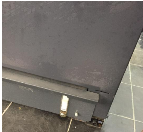
شكل رقم ١٦: فحص مستوى الزيت من خلال مبيّن المستوى الزجاجي
