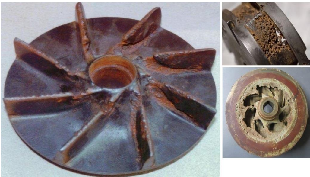
شكل رقم ١٥: بعض الأضرار التي تسببها ظاهرة التكهف في دفاعة المضخة
