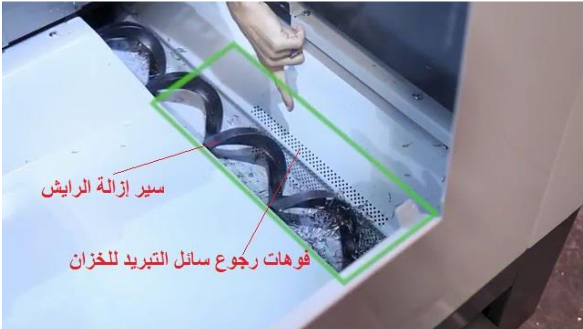
شكل رقم ٣٠: التأكد عمل سير الرايش اعلى درج زيت التبريد
