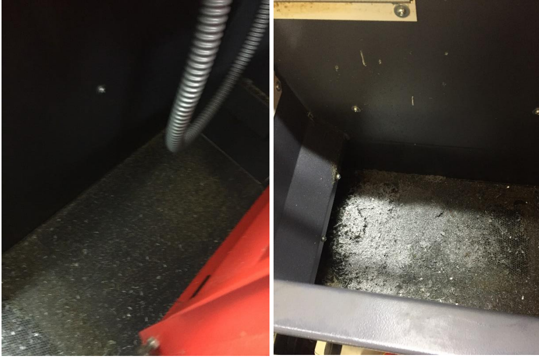
شكل رقم ٢٩: درج الرايش و التأكد من خلوه من الرايش
