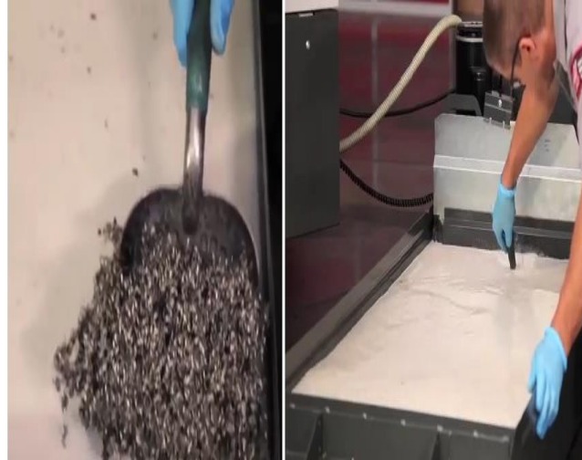
شكل رقم ٢٧: التأكد من إزالة الرايش من درج زيت التبريد
