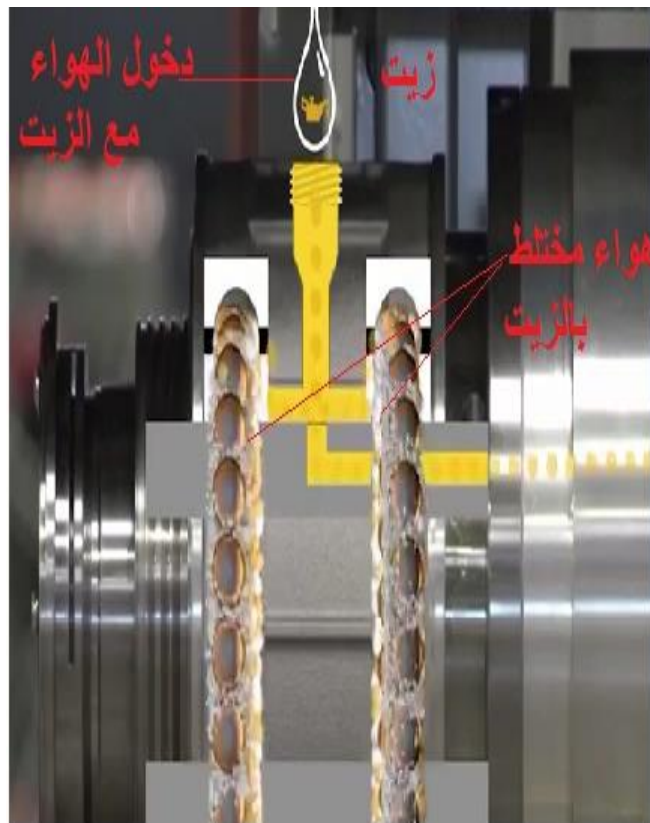
(ج) اختلاط الهواء مع الزيت
