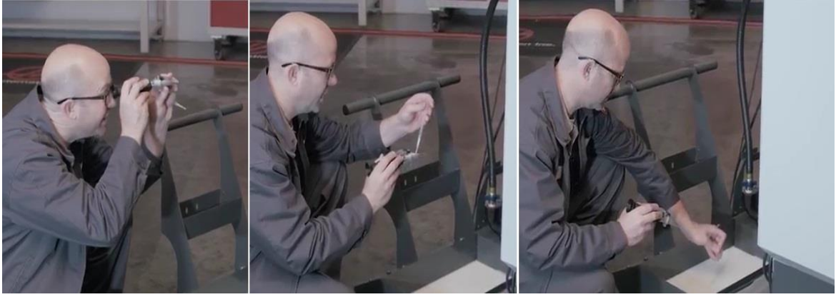
شكل رقم ٥: فحص عينة سائل التبريد
