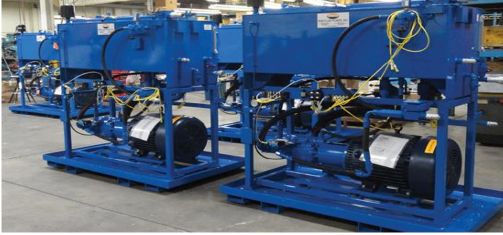
شكل رقم ٦٠: وحدة إنتاج القدرة الهيدروليكية ذات الخزان العلوى
