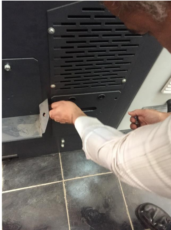
شكل رقم ٢: فك مسامير قاعدة حامل موتور ظلمبة زيت التبريد
