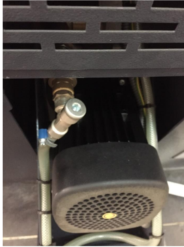
شكل رقم ٢١: فك قفيز ربط خراطيم زيت التبريد من وصلات ظلمبة التبريد
