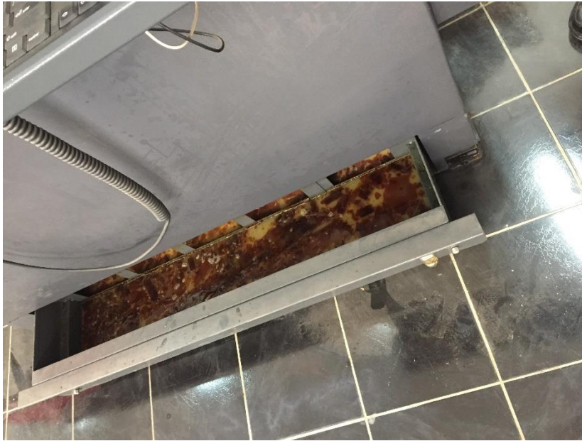
شكل رقم ٤: سحب درج سائل التبريد من اسفل الماكينة
