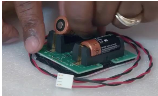
١٢. قم بإزالة طبقة البلاستيك الموجودة على الجزء اللاصق للوحة تثبيت البطاريات
