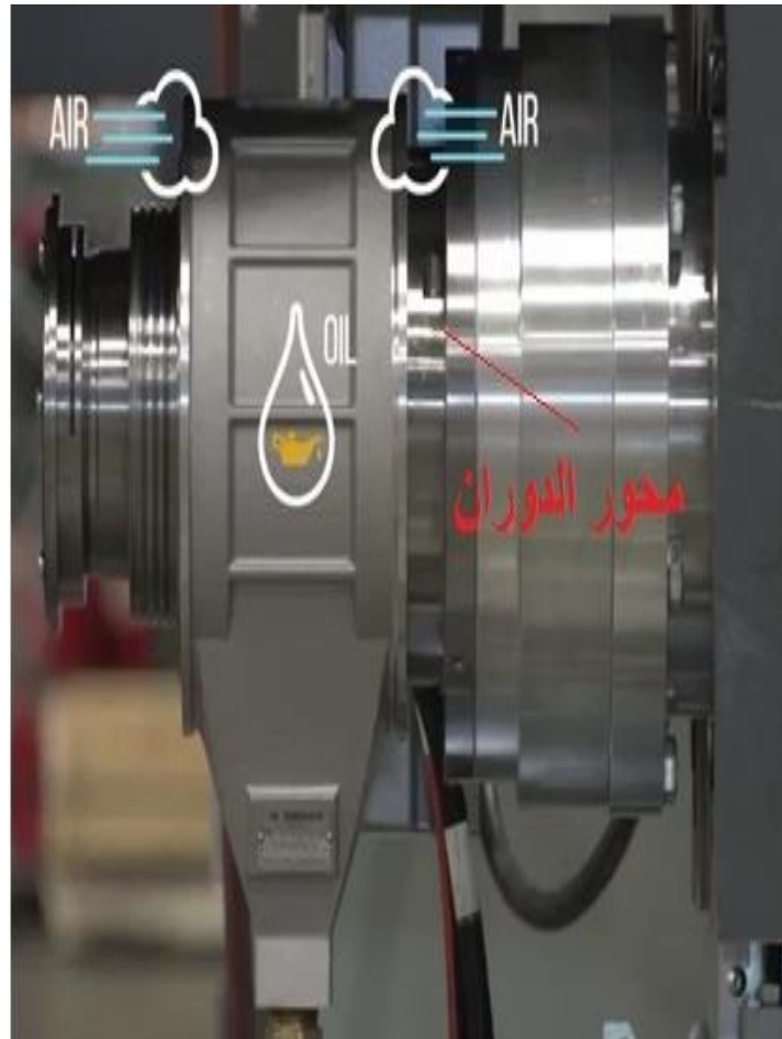
(ب) دخول هواء الى الزيت
