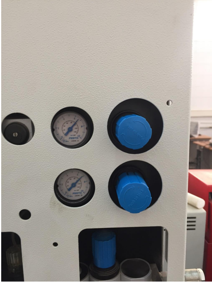
شكل رقم ٧٧: فحص ضغط عداد وحدة خدمة الهواء
