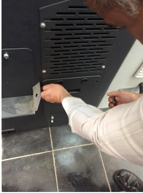
شكل رقم ١٧: فك مسامير قاعدة حامل موتور ظلمبة زيت التبريد
