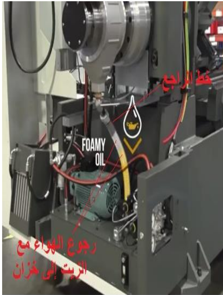
(د) رجوع هواء الى الزيت الى الخزان
