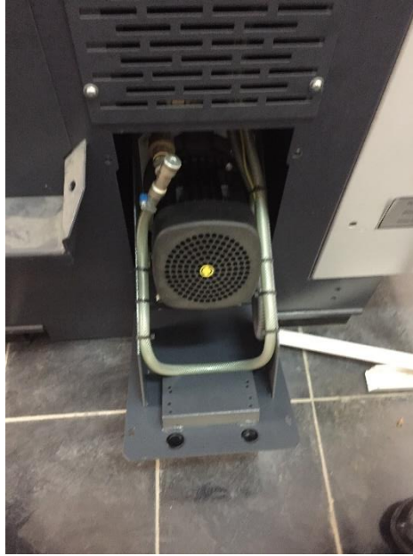
شكل رقم ١٨: إنزال قاعدة حامل موتور ظلمبة زيت التبريد للخارج
