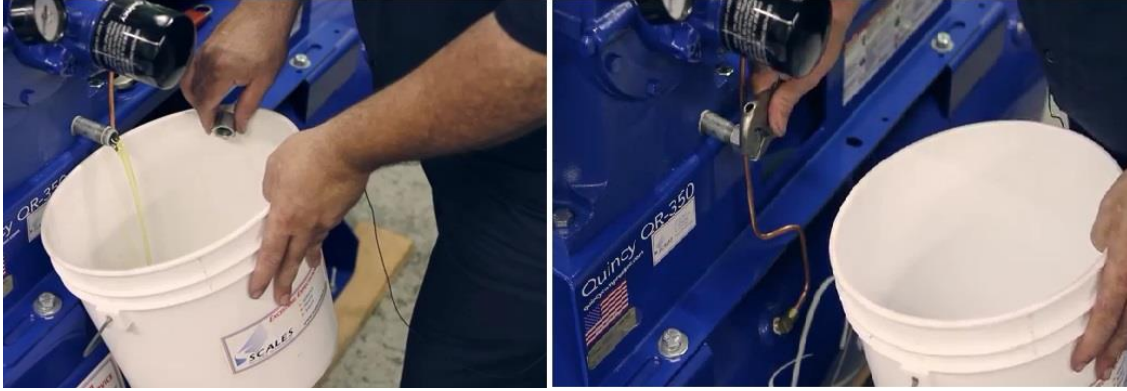
شكل رقم ٦٩: تفريغ الزيت
