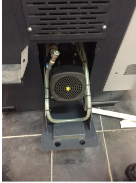
شكل رقم ٣: إنزال قاعدة حامل موتور ظلمبة زيت التبريد للخارج
