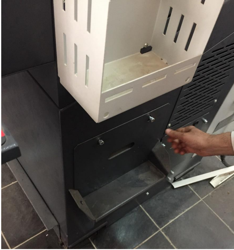
شكل رقم ١٢: إعادة ربط حامل موتور زيت التبريد
