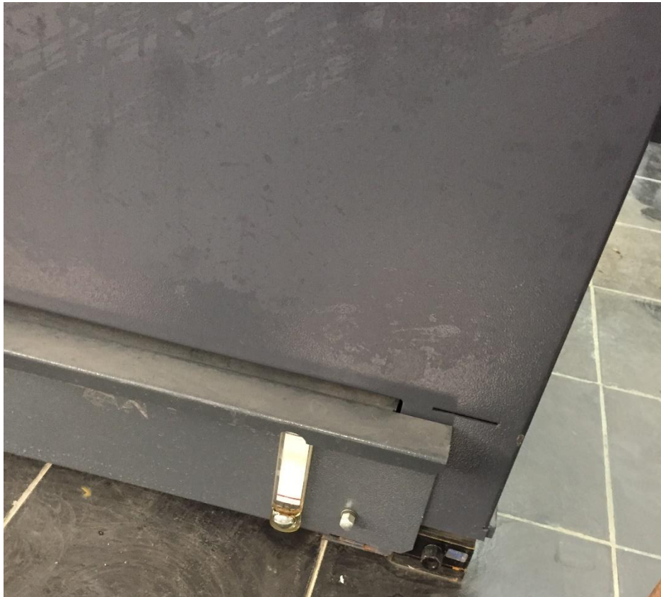
شكل رقم ١: فحص مستوى الزيت من خلال المبين الزجاجي
