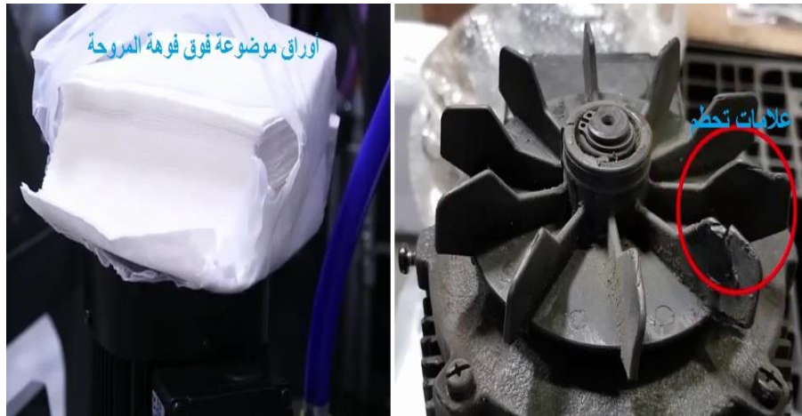
شكل رقم ٢٣: فحص ريشة طلمبة التبريد
