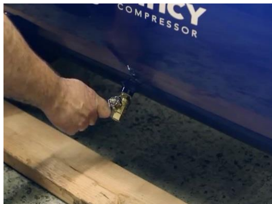
شكل رقم ٦٨: تفريغ هواء الضاغط
