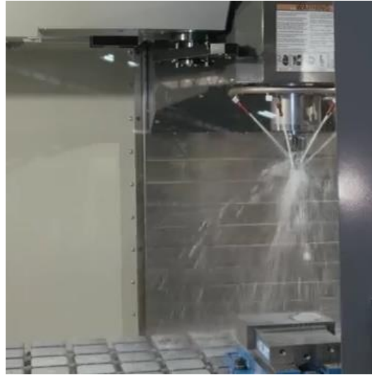
شكل رقم ١٣: التأكد من تشغيل زيت التبريد
