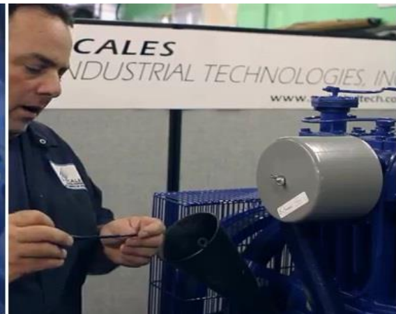
شكل رقم ٧٤: تنظيف عصا الزيت قبل ارجاعها
